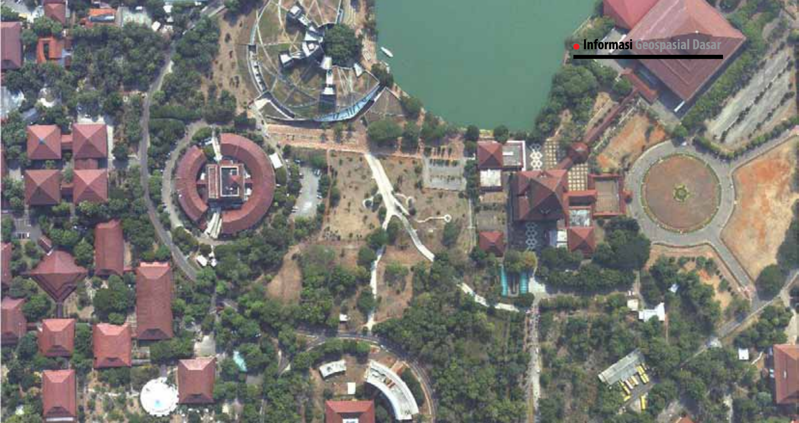
Orthophoto untuk keperluan pembuatan peta Skala 1:5.000 (Lokasi Universitas Indonesia, Depok).
