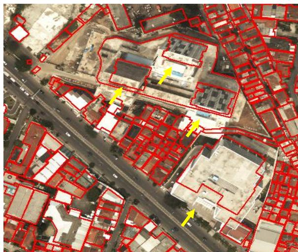
**Gambar 2.** Pergeseran *orthophoto* dengan vektor bangunan peta RBI 1:5.000 (lihat tanda panah kuning).
