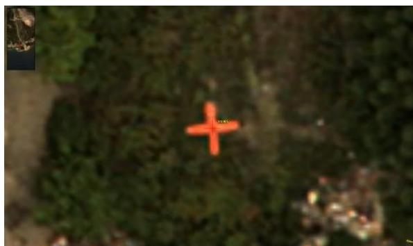
**Gambar 4.** ICP dalam bentuk *premark*.
